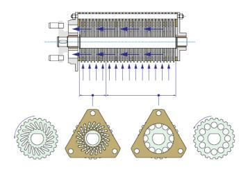
Gli elementi filtranti sono divisi in due parti; il primo, sulla destra del disegno, consiste di due set di dischi speciali, assemblati alternativamente, uno rotante con l'albero interno, l'altro fissato al corpo.la distanza tra i dischi rappresenta il GRADO DI FILTRAGGIO, mentre la quantità è la SUPERFICIE FILTRANTE. La scelta dipende dal flusso e dalla viscosità del compound. La seconda parte dell'elemento di filtraggio è vicino
