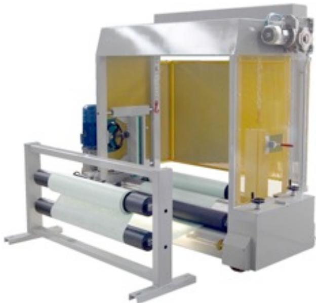
Occorre tenere presente che il sistema di avvolgimento consente di arrotolare in un solo senso, cioè con la superficie superiore della membrana in produzione all'esterno del rotolo, per esempio, con l'ardesia che si vede a rotolo finito.
